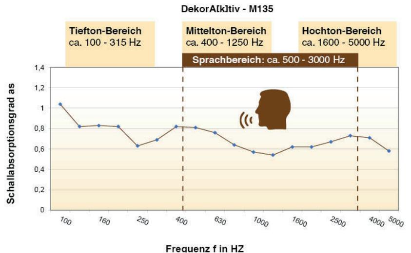
Schallabsorptionsgrad ( $\alpha_s$ ) nach DIN EN ISO 354
